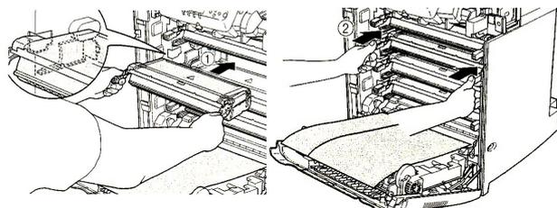
7. 搬送ベルトに置いた用紙を取り除き、ETBユニットを閉めます。
