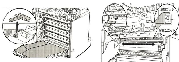
4. 交換するカートリッジの左右の取っ手をしっかり持ち、引き抜きます。
