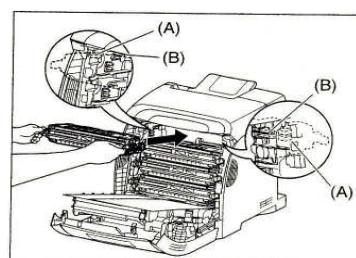
7. 搬送ベルトに置いた用紙を取り除き、ETBユニットを閉めます。
