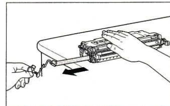
6. カートリッジの(A)をプリント本体のスロット(B)に合わせて止まるまで差し込みます。さらにしっかりと奥まで押し込みます。
